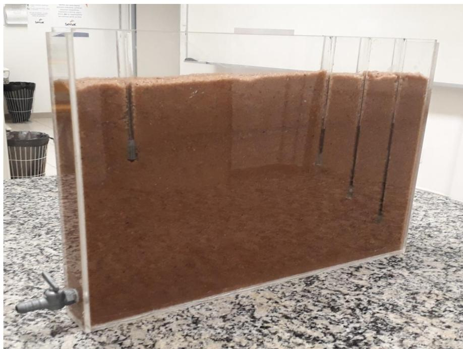
**Figura 10: Modelo de aquífero granular.**
