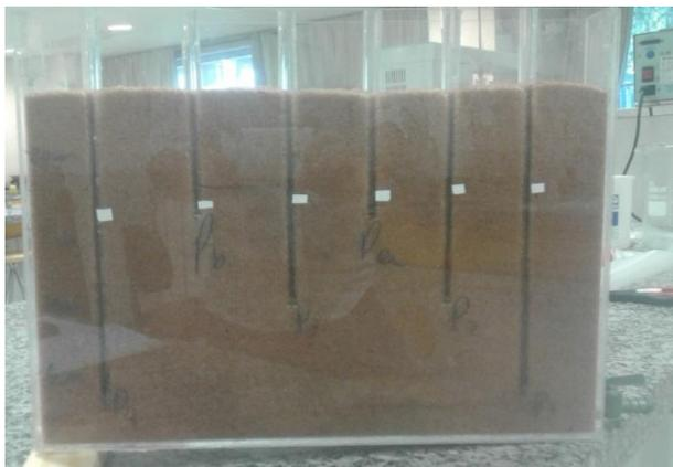
Figura 6: Modelo com contaminante com o nível da água subterrânea marcada em branco.
