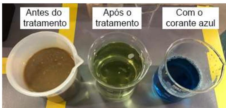
Figura 4: Amostras de esgoto em diferentes etapas do tratamento para reuso realizado no Shopping JK Iguatemi.
